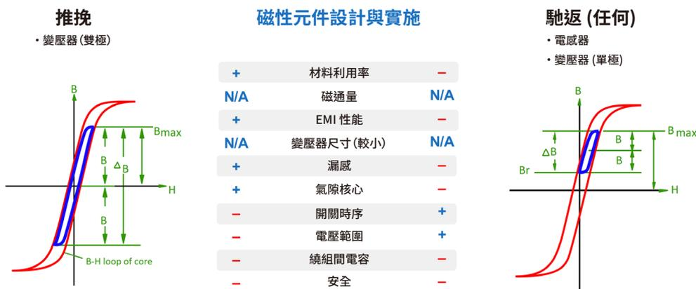
圖 2: 此圖表顯示與每種拓撲的操作模式(藍色)相反的材料磁滯迴線(紅色)。
