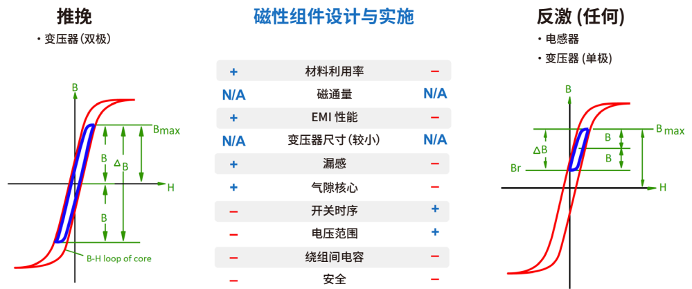
图 2: 此图表显示与每种拓扑的操作模式(蓝色)相反的材料磁滞回线(红色)。
